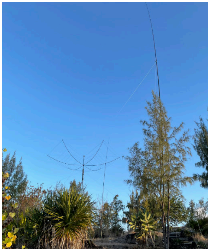
Die Antennenanlage von 3B9KW (v.l.n.r.): Buddihex (20/15/10), 40m-Vertikal, 160m Inverted-L
