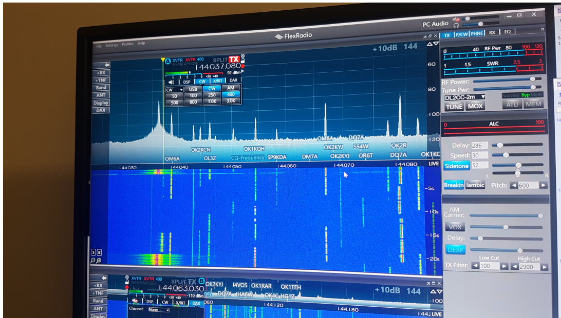
Abbildung 2: Spektrale Aufnahme verschiedener Signale bei DQ2C. Unser Signal schaut etwas breit aus, könnte am TX liegen aber evtl. ist auch der RX übersteuert.
